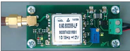
Bild 5: Aufbau des Messoszillators zur Bestimmung des Phasenrauschens
