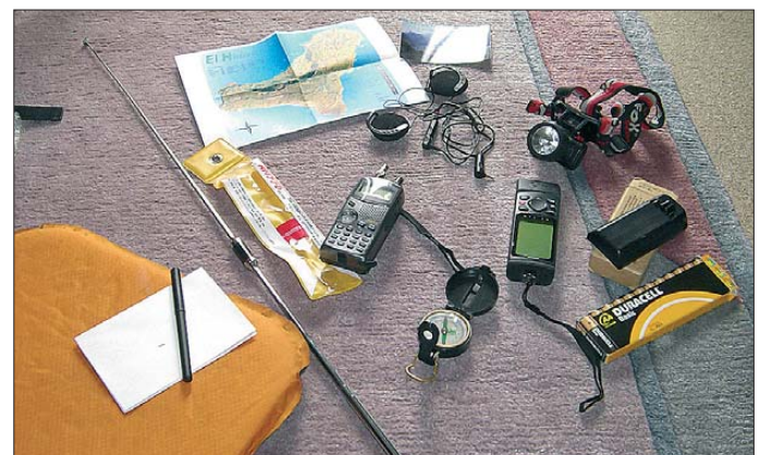
Bild 6: Eine typische portable Funkstation inklusive Zubehör für den Betrieb über FM-Amateurfunk-Satelliten Fotos und Screenshots: DL7VTX
