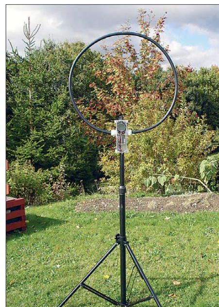
Bild 3: Ansicht der 40-m-Version mit 0,73 m Schleifendurchmesser
