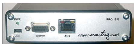
Bild 4: Frontansicht des RRC-1258; (v. l. n. r.) Mini-USB-Anschluss für zukünftige Erweiterungen, Power-LED, RS232-Port für Erweiterungen wie Rotorsteuerung, AUX-Buchse zum Anschluss von Bedienteil oder/und Mikrofon/Lautsprecher
