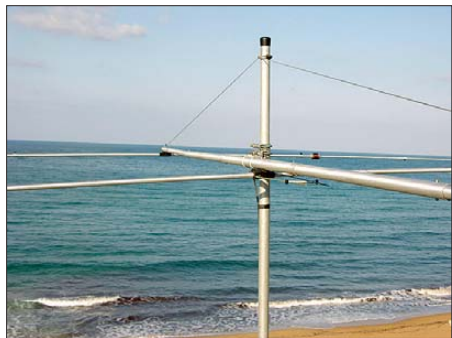
Bild 3: Einzelheiten zu Masthalterung und einstellbarer Haarnadelschleife; die Abstrahlung mit abfallendem Gelände und 30 m Höhe über Salzwasser ersetzt problemlos eine Linearendstufe. Davon kann man in bebauten Gegenden nur träumen ...
