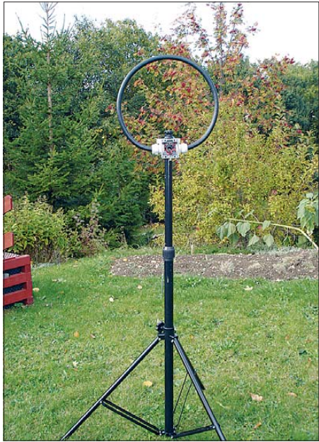
Bild 4: Ansicht der 20-m-Version mit 0,39 m Schleifendurchmesser
