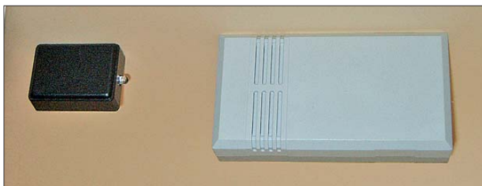
Bild 1: Die Musterbaugruppe der Sprachausgabe (rechts) wurde in ein Gehäuse mit Lautsprecheröffnung eingebaut. Der IR-Sender fand im wasserdichten Gehäuse seinen Platz.
