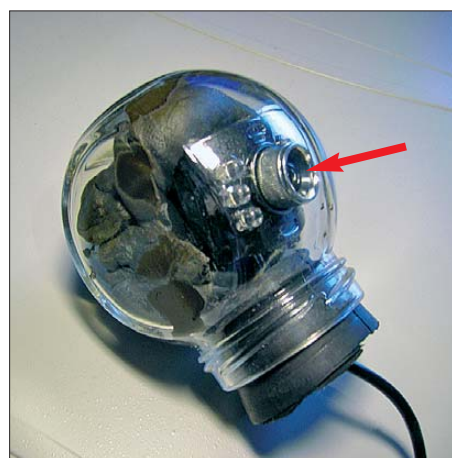
Bild 1: Die Kamera ist im Behälter leicht nach unten gerichtet, um die Umgebung besser erkennen zu können.
