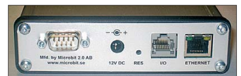
Bild 5: Rückansicht des RRC-1258; (v. l. n. r.) RS232-Port parallelgeschaltet zur AUX-Buchse auf der Frontseite, Stromversorgungsanschluss, I/O-Port zum Anschluss von Morsetaste und dergleichen, Netzwerkanschluss
