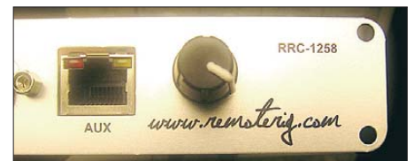
Bild 9: Um die Geschwindigkeit des Keyers komfortabler einzustellen, lässt sich ein Potenziometer im RRC-1258 auf der Steuerseite einbauen.
