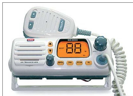
Das in Australien von GME entwickelte CB-Funkgerät GX300 lässt sich je nach Programmierung auch auf den südafrikanischen 29-MHz-Kanälen betreiben. Das Bild zeigt die Version mit den australischen 11-m-Marinekanälen. Foto: Werkfoto
