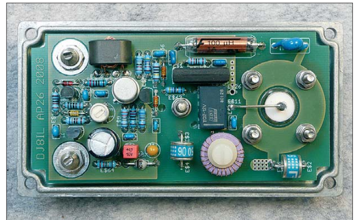
Bild 13: Bestückte Musterplatine, auf dem Gehäuseboden montiert
