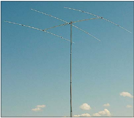
Bild 6: Der Originalaufbau ohne Überzug verbiegt und verwindet sich doch erheblich.
