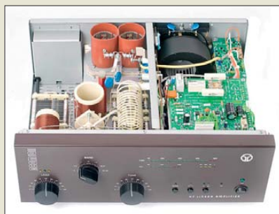
Die 700-W-Endstufe Acom 1011 ist mit zwei 4CX250B bestückt.
