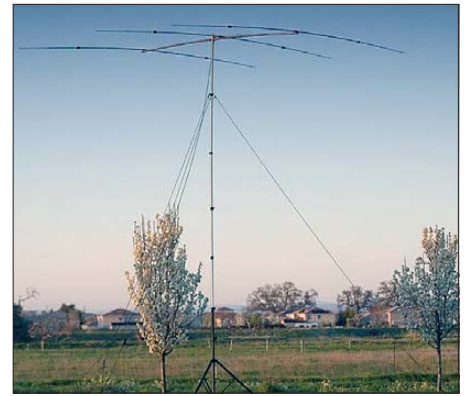
Bild 2: Mit dem lieferbaren Portabelmast kommt die YP-3 auf 6,85 m Höhe.
