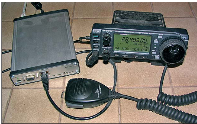
Bild 1: Das abgesetzte Bedienteil des Icom IC-706MkIIIG ist auf der Steuerseite mit einem RRC-1258 verkabelt.
