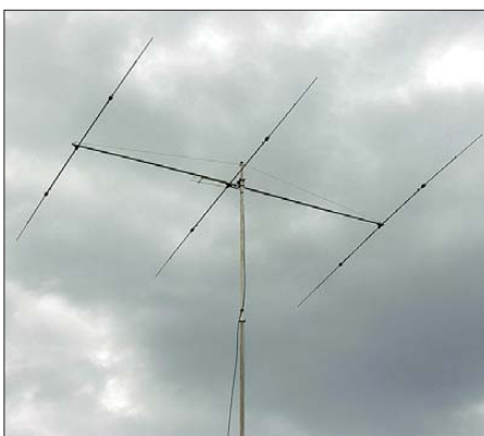
Bild 8: Durch die zusätzliche Abspannung wird die Konstruktion deutlich stabiler.
