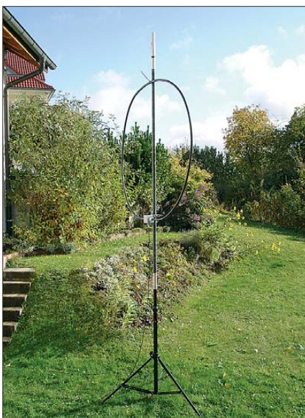
Bild 8: Ansicht der 80-m-Version mit 1,40 m Schleifendurchmesser Fotos: DK8ZV
